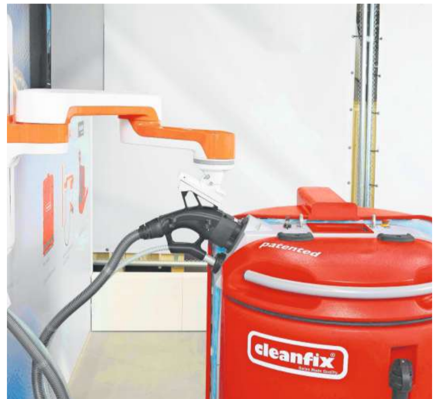
Der vollautomatische Reinigungsroboter an der Dockingstation.
