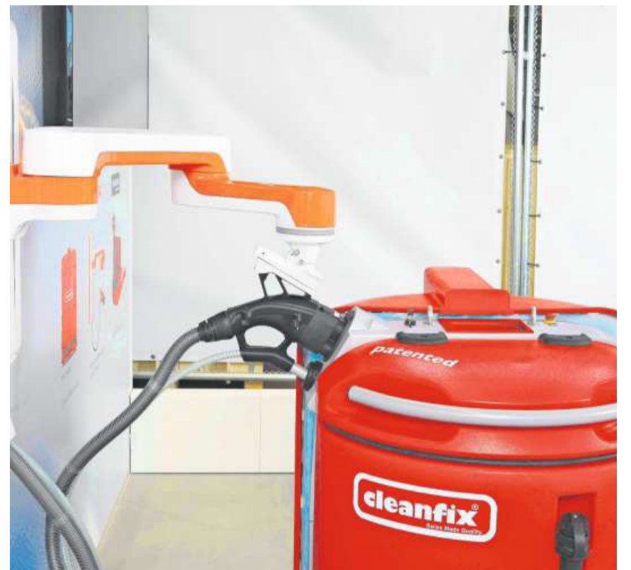
Der vollautomatische Reinigungsroboter an der Dockingstation.
